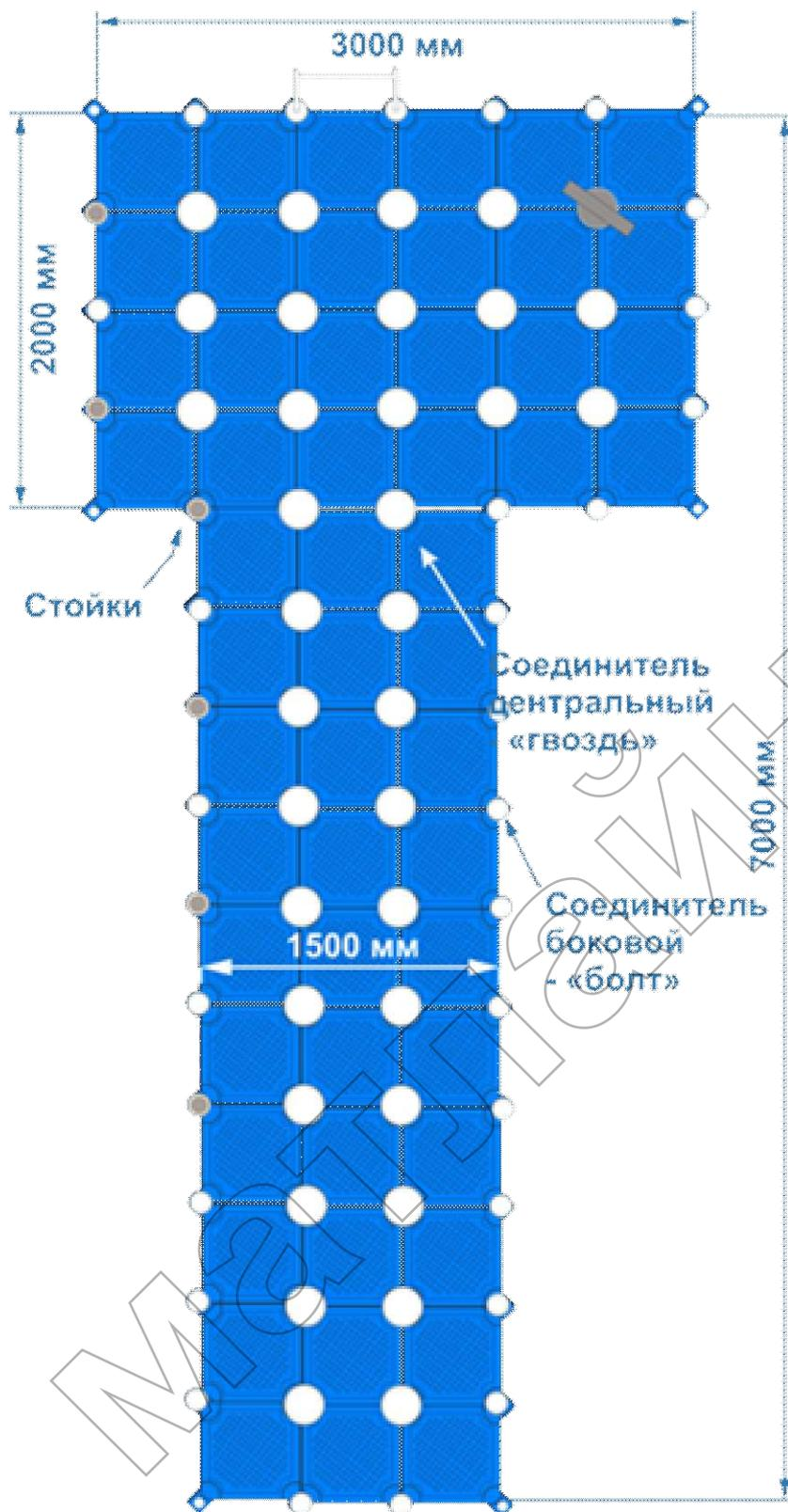
Пример сборки причала классической формы для швартовки маломерных судов, рыбной ловли и купания из модулей размером 500x500.
