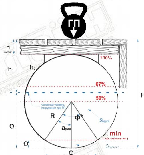
дополнительно установленная обрешетка с настилом имеют определенный вес, то желательно, чтобы понтон погружался в воду без груза на 25-35%. Это даст запас плавучести и устойчивости Вашей конструкции.
