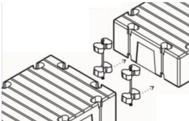
3. В зависимости от назначения рым-гайка M12 (рым-болт) устанавливается ушком вверх или вниз. Ключ на 19. Вариант вниз – для якоря, вариант вверх – для растяжки тросами или крепления лодок.
