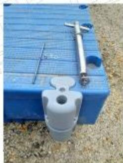
Снизу на шпильку накручивается вторая гайка
