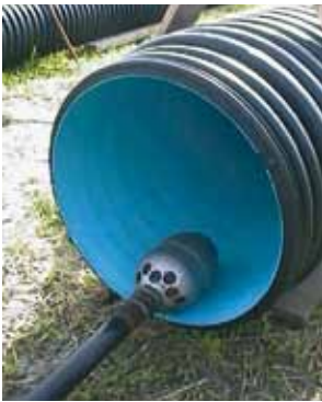
Abrasion tests using probes. Essais d'abrasion au moyen de sondes. Prüfung des Abriebwiderstandes mittels Sonde.
