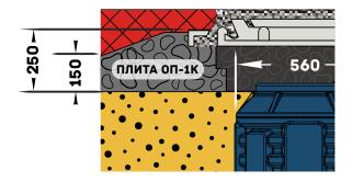
При установке кабельного колодца КС-5 и его модификаций на территории проезжей части обязательно применение разгрузочных железобетонных конструкций, а также анкерных плит. Для разгрузки колодца рекомендуем использовать опорную плиту ОП-1К в комплекте с люком.
