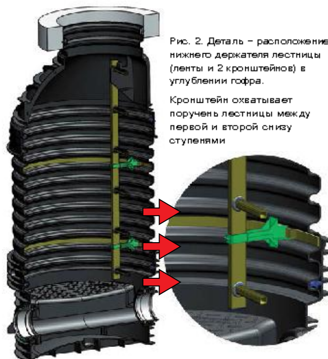
Рис.1. Лестница из стеклопластика в колодце Tegra 1000 NG
