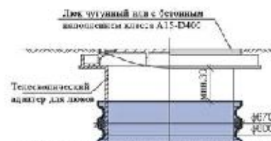
Люк A15, B125 или D400 на телескопическом адаптере
