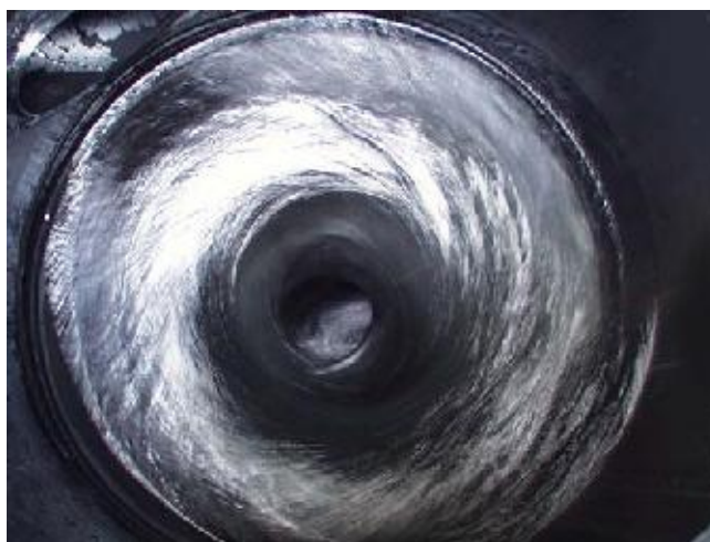
Характер потока в колодце для гашения скорости потока
