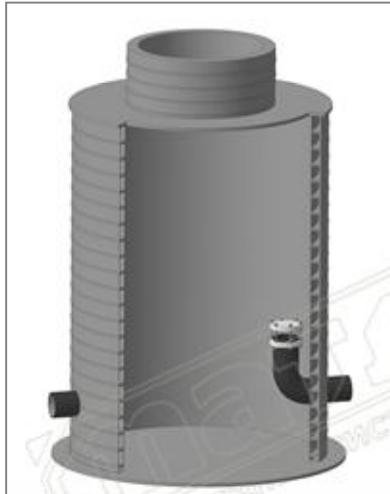
В колодце на входном патрубке устанавливается специально изготовленный отвод с втулкой, накидным и глухим фланцами, соединенными между собой болтами. Вода под напором попадает в глухой фланец и падает на дно колодца. Далее самотеком через выходной патрубок попадает в трубопровод. Возможны другие варианты исполнения гасителя напора.
