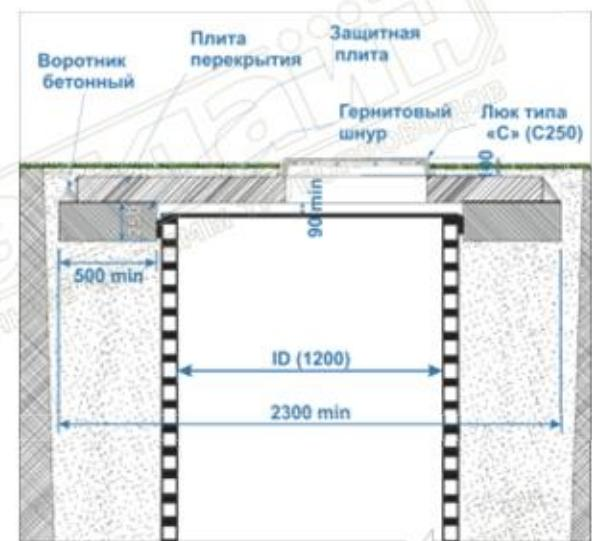
Пример: колодец ID1200 без горловины, защитная плита диаметр 2300, плита перекрытия ПД10
