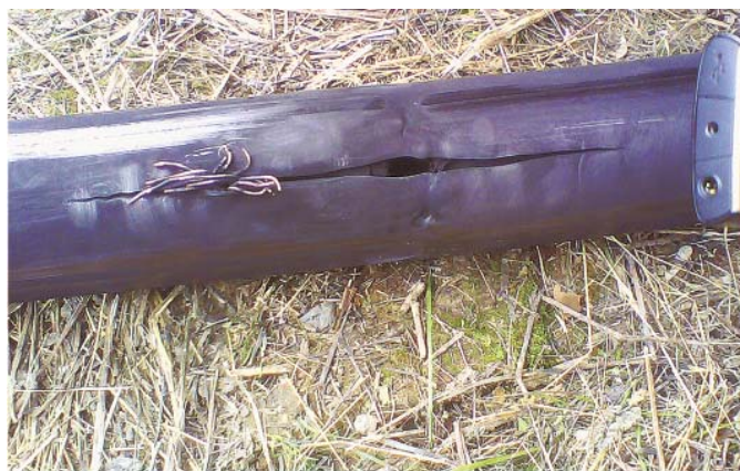
Рис. 5. Однофазное короткое замыкание на землю в целом месте, фаза «Ж» линии 220 кВ «Очаково» — «Магистральная 1-1» (Москва)
