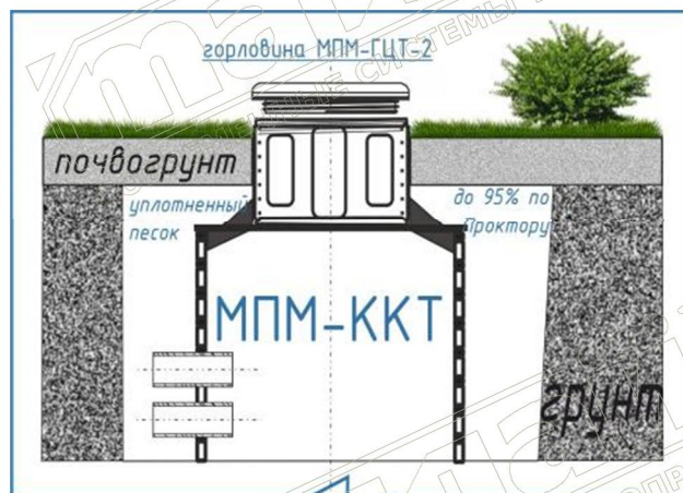
Установка колодца с МПМ-ГЦТ-2
