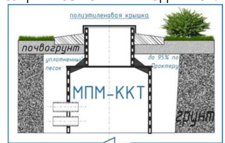
Полиэтиленовая крышка, отмостка из бетона
