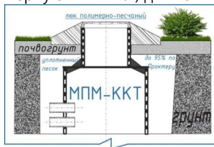
Полимерно-песчаный люк, отмостка из бетона
