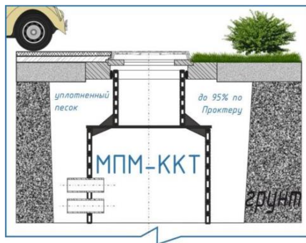
Пример размещения чугунного люка ГОСТ на ж/б плите тип ПП10 с доборным кольцом
