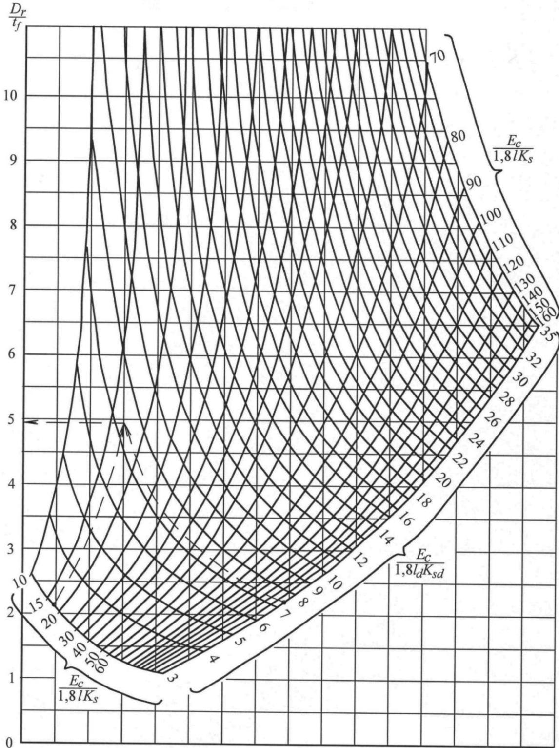
Рисунок М.2 – Номограмма для определения соотношения  $\frac{D_r}{t_f}$
