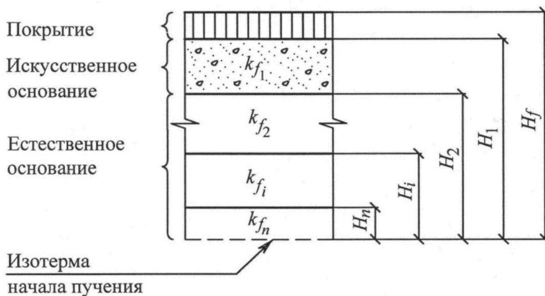
**Рисунок Е.1 – Расчетная схема слоистого основания**
