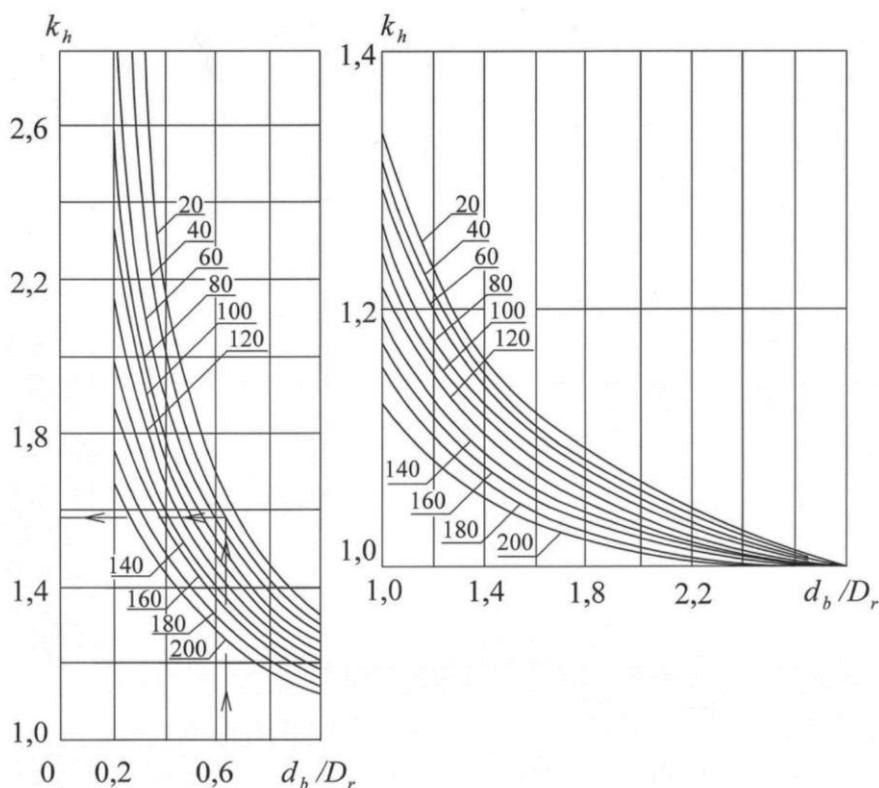
**Рисунок Г.1 – График для определения коэффициента  $k_h$  жесткого массива. Цифрами на кривых указан коэффициент постели слоя основания  $K_{sr}$ , МН/м<sup>3</sup>, лежащего на жестком массиве**
