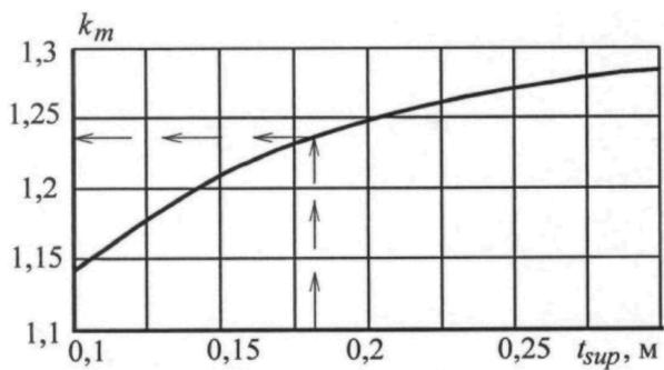
**Рисунок К.3 – График для определения поправочного коэффициента  $k_m$  при расчете толщины усиления бетонного покрытия  $t_{sup}$**
