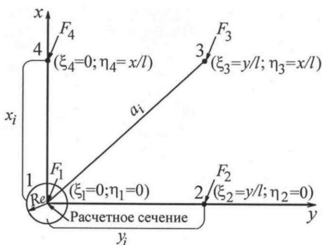
**Рисунок 7.2 – Расчетная схема параметров нагружения опор ВС**
