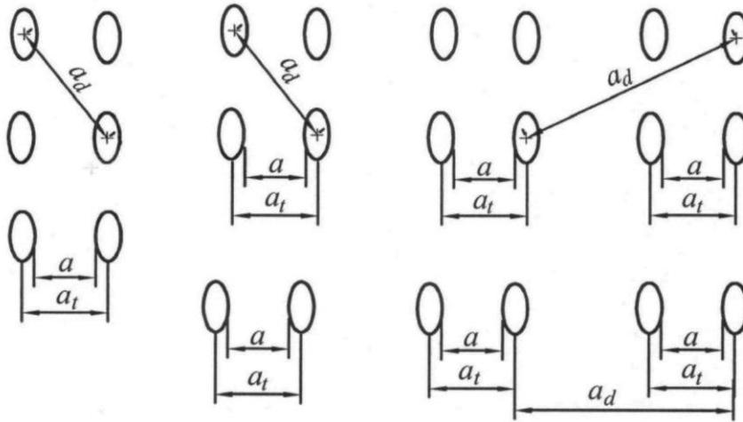
**Рисунок К.7 – Расчетные расстояния  $a$ ,  $a_t$ ,  $a_d$  между колесами
