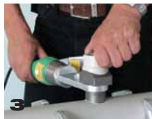
3 Вварное седло надеть на насадку так, чтобы были совмещены риски на седле и наконечнике. Прогреть отверстие и ввариваемое седло. Время прогрева как у трубы диаметром 32 мм - 8 с.
