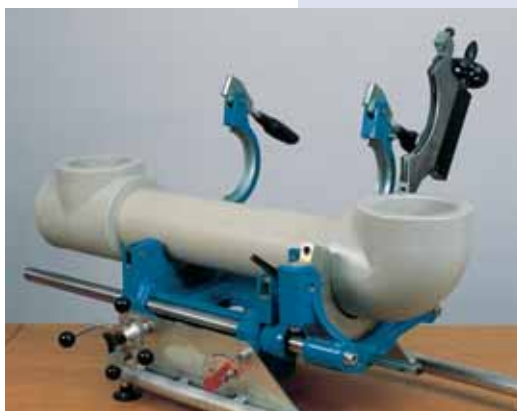
готовое сварное соединение после охлаждения
