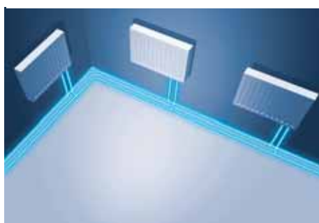
Двухтрубная кольцевая система
